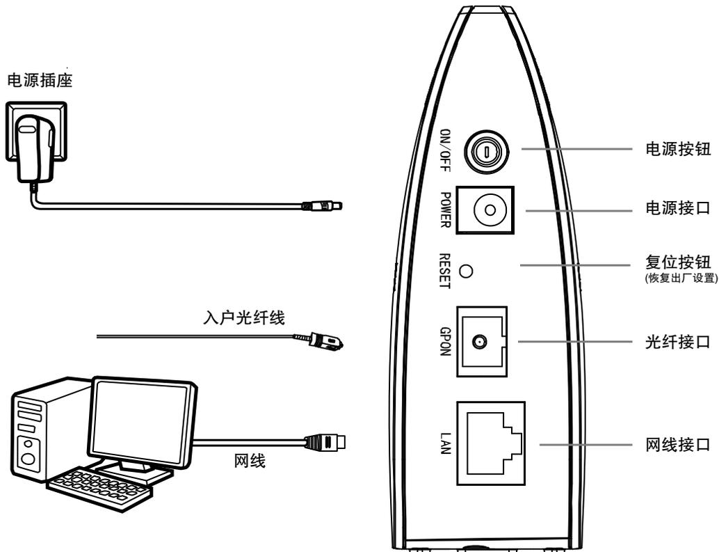
图 3-1 TL-GP110 硬件安装示意图
